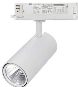
Tracklight réglable pour rail triphasé universel Eutrack. Boîtier blanc RAL9016 équipé avec puce LED Citizen à haut rendu des couleurs CRI90 et réflecteur Alanod de 30° avec un rendement de 97%. Adaptateur de rail Powergear avec driver Osram flickr free intégré, non dimmable. Durée de vie 50.000 heures L80B20, garantie 5 ans.
