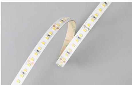
Ruban LED de la série ADVANCED. Le ruban est composée de 140 LED SMD par mètre et a une classe énergétique E. Convient aux environnements intérieurs et secs: IP20. Rouleau de 5m. Puissance de 6,5 W/m. Le ruban de LED est contrôlée par une tension de 24Vdc. Le ruban fournit 750Lm/m et a une température de couleur de 6500K avec un IRC de >90. Le ruban est dimmable via PWM
