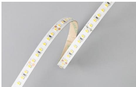
Ruban LED de la série ADVANCED. Le ruban est composée de 140 LED SMD par mètre et a une classe énergétique E. Convient aux environnements intérieurs et secs: IP20. Rouleau de 5m. Puissance de 8,5 W/m. Le ruban de LED est contrôlée par une tension de 24Vdc. Le ruban fournit 1000Lm/m et a une température de couleur de 6500K avec un IRC de >90. Le ruban est dimmable via PWM
