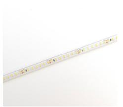
Ruban LED de la série ADVANCED. Le ruban est composée de 140 LED SMD par mètre et a une classe énergétique F. Convient aux environnements extérieurs et humides : IP67. Rouleau de 5m. Puissance de 8,4 W/m. Le ruban de LED est contrôlée par une tension de 24Vdc. Le ruban fournit 1000 Lm/m et a une température de couleur de 3000K avec un IRC de >90. Le ruban est dimmable via PWM
