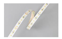
Ruban LED de la série ADVANCED. Le ruban est composée de 140 LED SMD par mètre et a une classe énergétique E. Convient aux environnements intérieurs et secs: IP20. Rouleau de 5m. Puissance de 10,5W/m. Le ruban de LED est contrôlée par une tension de 24Vdc. Le ruban fournit 1250Lm/m et a une température de couleur de 3000K avec un IRC de >90. Le ruban est dimmable via PWM
