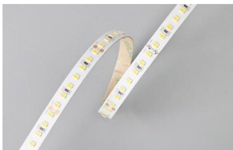
Ruban LED de la série ADVANCED. Le ruban est composée de 140 LED SMD par mètre et a une classe énergétique E. Convient aux environnements intérieurs et secs: IP20. Rouleau de 5m. Puissance de 13,5W/m. Le ruban de LED est contrôlée par une tension de 24Vdc. Le ruban fournit 1500Lm/m et a une température de couleur de 6500K avec un IRC de >90. Le ruban est dimmable via PWM
