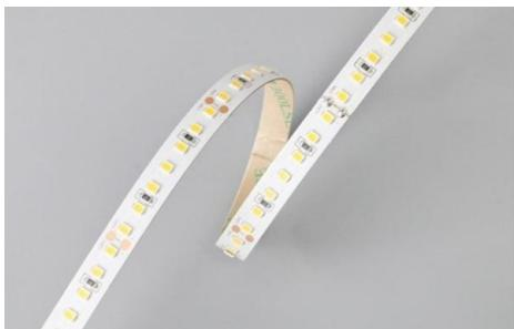
Ruban LED de la série ADVANCED. Le ruban est composée de 140 LED SMD par mètre et a une classe énergétique E. Convient aux environnements intérieurs et secs: IP20. Rouleau de 5m. Puissance de 15,5 W/m. Le ruban de LED est contrôlée par une tension de 24Vdc. Le ruban fournit 1750Lm/m et a une température de couleur de 6500K avec un IRC de >90. Le ruban est dimmable via PWM
