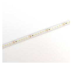
Ruban LED de la série ADVANCED. Le ruban est composée de 140 LED SMD par mètre et a une classe énergétique F. Convient aux environnements extérieurs et humides : IP67. Rouleau de 5m. Puissance de 14,4 W/m. Le ruban de LED est contrôlée par une tension de 24Vdc. Le ruban fournit 1750 Lm/m et a une température de couleur de 4000K avec un IRC de >90. Le ruban est dimmable via PWM
