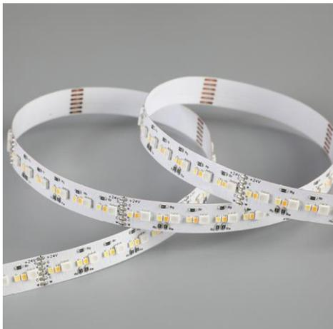
Ruban LED multicolore RGB-TW de la série ADVANCED. Le ruban est composée de 60 LED SMD par mètre avec des LEDs séparés pour le couleur blanc. Le blanc varie de 2200K à 6500K. Le ruban a une puissance de 19,2W/m et une classe énergétique F. Convient aux environnements intérieurs et secs: IP20. Rouleau de 5m. Le ruban de LED est contrôlée par une tension de 24Vdc. Le ruban fournit 1119 Lm/m avec un IRC de >80. Le ruban est dimmable via PWM.
