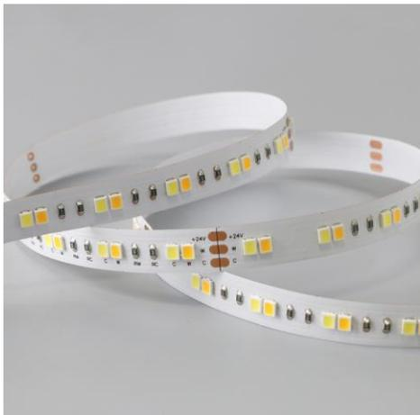
Ruban LED monocolore TW de la série ADVANCED. Le ruban est composée de 60 LED SMD par mètre. Le température de couleur varie de 2200K à 6500K. Le ruban a une puissance de 14,4W/m et une classe énergétique F. Convient aux environnements intérieurs et secs: IP20. Rouleau de 5m. Le ruban de LED est contrôlée par une tension de 24Vdc. Le ruban fournit 1296 Lm/m avec un IRC de >90. Le ruban est dimmable via PWM.
