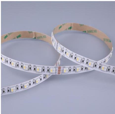
Ruban LED multicolore RGB-W de la série ADVANCED. Le ruban est composée de 60 LED SMD par mètre avec des LEDs séparés pour le couleur blanc. Le ruban a une puissance de 16W/m et une classe énergétique F. Convient aux environnements intérieurs et secs: IP20. Rouleau de 5m. Le ruban de LED est contrôlée par une tension de 24Vdc. Le ruban fournit 945 Lm/m et a une température de couleur de 4000K avec un IRC de >80. Le ruban est dimmable via PWM.
