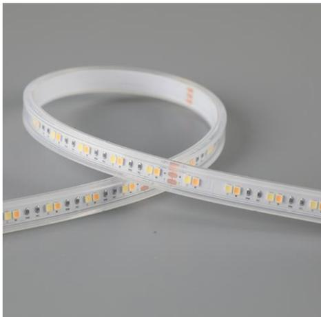
Ruban LED monocolore TW de la série ADVANCED. Le ruban est composée de 60 LED SMD par mètre. Le température de couleur varie de 2200K à 6500K. Le ruban a une puissance de 14,4W/m et une classe énergétique F. Convient aux environnements extérieurs et humides: IP67. Rouleau de 5m. Le ruban de LED est contrôlée par une tension de 24Vdc. Le ruban fournit 1224 Lm/m avec un IRC de >90. Le ruban est dimmable via PWM.
