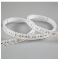
Ruban LED multicolore RGB-W de la série ADVANCED. Le ruban est composée de 60 LED SMD par mètre avec des LEDs séparés pour le couleur blanc. Le ruban a une puissance de 16W/m et une classe énergétique F. Convient aux environnements extèrieurs et humides: IP67. Rouleau de 5m. Le ruban de LED est contrôlée par une tension de 24Vdc. Le ruban fournit 863 Lm/m et a une température de couleur de 3000K avec un IRC de >80. Le ruban est dimmable via PWM.
