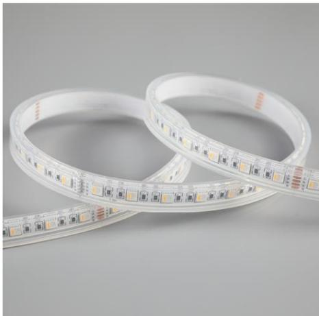
Ruban LED multicolore RGB-W de la série ADVANCED. Le ruban est composée de 60 LED SMD par mètre avec des LEDs séparés pour le couleur blanc. Le ruban a une puissance de 16W/m et une classe énergétique F. Convient aux environnements extérieurs et humides: IP67. Rouleau de 5m. Le ruban de LED est contrôlée par une tension de 24Vdc. Le ruban fournit 927 Lm/m et a une température de couleur de 4000K avec un IRC de >80. Le ruban est dimmable via PWM.
