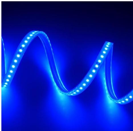
Ruban LED monocolore bleu de la série ADVANCED. Le ruban est composée de 140 LED SMD bleu par mètre. Le ruban a une puissance de 6,3W/m et une classe énergétique F. Convient aux environnements extérieurs et humides: IP67. Rouleau de 5m. Le ruban de LED est contrôlée par une tension de 24Vdc. Le ruban fournit 115 Lm/m et a une température de couleur de K avec un IRC de >. Le ruban est dimmable via PWM.
