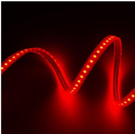
Ruban LED monocolore rouge de la série ADVANCED. Le ruban est composée de 140 LED SMD rouge par mètre. Le ruban a une puissance de 6,3W/m et une classe énergétique F. Convient aux environnements extérieurs et humides: IP67. Rouleau de 5m. Le ruban de LED est contrôlée par une tension de 24Vdc. Le ruban fournit 194 Lm/m et a une température de couleur de K avec un IRC de >. Le ruban est dimmable via PWM.
