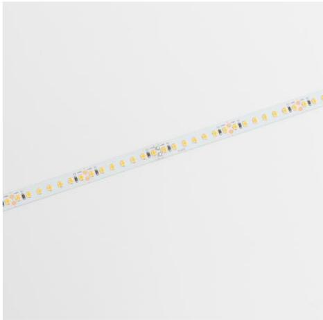
Ruban LED de la série PERFORMANCE. Le ruban se distingue par un plus grand longueur. Le ruban est composée de 140 LED par mètre avec une puissance de 3,8W/m et a une classe énergétique F. Convient aux environnements intérieurs et secs: IP20. Rouleau de 50m. Le ruban de LED est contrôlée par une tension de 48Vdc. Le ruban fournit 500 Lm/m et a une température de couleur de 2700K avec un IRC de >90. Le ruban est dimmable via PWM.
