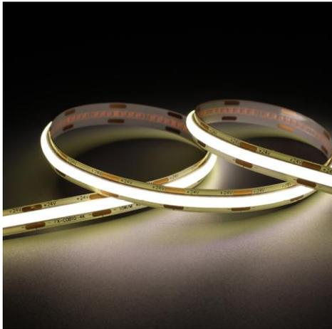
Ruban LED de la famille PERFORMANCE. Le ruban se distingue par un effet d'éclairage uniforme grâce à l'utilisation d'un autre type de LED. Le ruban est composée de 384 LED COB par mètre avec une puissance de 4,8W/m et a une classe énergétique F. Convient aux environnements intérieurs et secs: IP20. Rouleau de 5m. Le ruban de LED est contrôlée par une tension de 24Vdc. Le ruban fournit 500 Lm/m et a une température de couleur de 2700K avec un IRC de >90. Le ruban est dimmable via PWM.
