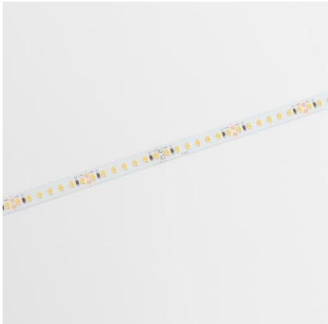
Ruban LED de la série PERFORMANCE. Le ruban se distingue par un plus grand longueur. Le ruban est composée de 140 LED par mètre avec une puissance de 3,8W/m et a une classe énergétique F. Convient aux environnements intérieurs et secs: IP20. Rouleau de 20m. Le ruban de LED est contrôlée par une tension de 48Vdc. Le ruban fournit 500 Lm/m et a une température de couleur de 3000K avec un IRC de >90. Le ruban est dimmable via PWM.
