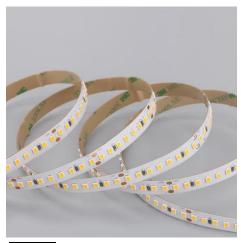
Ruban LED de la famille PERFORMANCE. Le ruban se distingue par un plus grand longeur. Le ruban est composée de 160 LED par mètre avec une puissance de 3,3W/m et a une classe énergétique D. Convient aux envirronements intèrieurs et sec: IP20. Rouleau de 12m. Le ruban de LED est contrôlée par une tension de 24Vdc. Le ruban fournit 500 Lm/m et a une température de couleur de 4000K avec un IRC de >90. Le ruban est dimmable via PWM.
