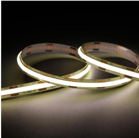
Ruban LED de la série PERFORMANCE. Le ruban se distingue par un effet d'éclairage uniforme grâce à l'utilisation d'un autre type de LED. Le ruban est composée de 384 LED COB par mètre avec une puissance de 4,8W/m et a une classe énergétique E. Convient aux environnements intérieurs et secs: IP20. Rouleau de 5m. Le ruban de LED est contrôlée par une tension de 24Vdc. Le ruban fournit 500 Lm/m et a une température de couleur de 4000K avec un IRC de >90. Le ruban est dimmable via PWM.
