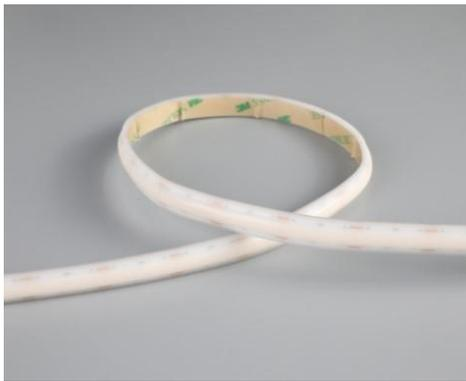
Ruban LED de la série PERFORMANCE. Le ruban se distingue par un effet d'éclairage uniforme grâce à l'utilisation d'un autre type de LED. Le ruban est composée de 304 LED SIL par mètre avec une puissance de 4,5W/m et a une classe énergétique E. Convient aux environnements extérieurs et humides: IP67. Rouleau de 5m. Le ruban de LED est contrôlée par une tension de 24Vdc. Le ruban fournit 500 Lm/m et a une température de couleur de 4000K avec un IRC de >90. Le ruban est dimmable via PWM.
