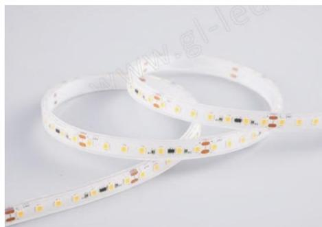
Ruban LED de la famille PERFORMANCE. Le ruban se distingue par sa résistance aux températures de fonctionnement élevées, jusqu'à 85°C. Le ruban est composée de 126 LED SMD par mètre avec une puissance de 6W/m et a une classe énergétique E. Convient aux environnements extérieurs en humides: IP67. Rouleau de 5m. Le ruban de LED est contrôlée par une tension de 24Vdc. Le ruban fournit 800 Lm/m et a une température de couleur de 4000K avec un IRC de >80. Le ruban est dimmable via PWM.
