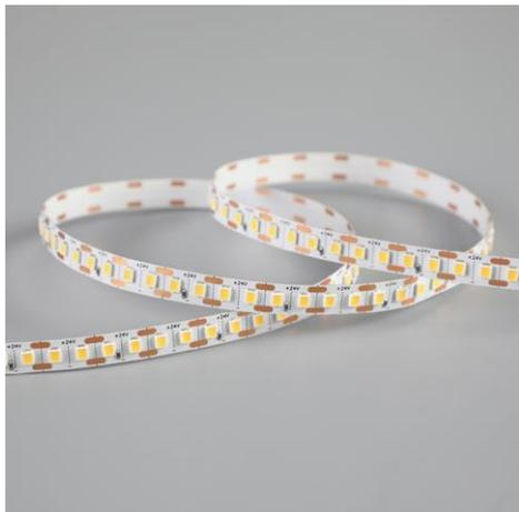
Ruban LED de la famille PERFORMANCE. Le ruban se distingue par un CRI élevé. Le ruban est composée de 160 LED par mètre avec une puissance de 6,3W/m et a une classe énergétique F. Convient aux environnements intérieurs et sec: IP20. Rouleau de 5m. Le ruban de LED est contrôlée par une tension de 24Vdc. Le ruban fournit 750 Lm/m et a une température de couleur de 2700K avec un IRC de >95. Le ruban est dimmable via PWM.
