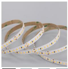
Ruban LED de la famille PERFORMANCE. Le ruban est composée de 160 LED SMD par mètre avec une puissance de 5W/m et a une classe énergétique D. Convient aux envirronements extèrieurs en humides: IP67. Rouleau de 5m. Le ruban de LED est contrôlée par une tension de 24Vdc. Le ruban fournit 750 Lm/m et a une température de couleur de 4000K avec un IRC de 90. Le ruban est dimmable via PWM.
