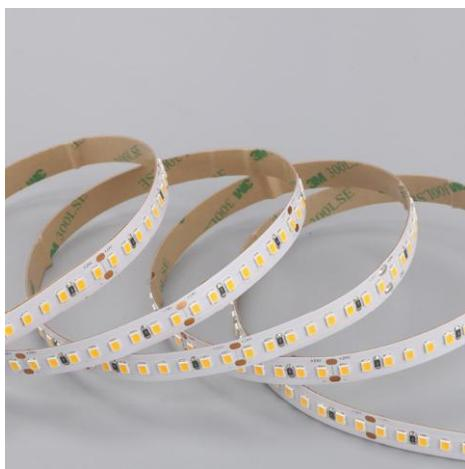
Ruban LED de la série PERFORMANCE. Le ruban est composée de 160 LED SMD par mètre avec une puissance de 5,2W/m et a une classe énergétique C. Convient aux environnements intérieurs et secs: IP20. Rouleau de 5m. Le ruban de LED est contrôlée par une tension de 24Vdc. Le ruban fournit 750 Lm/m et a une température de couleur de 6500K avec un IRC de >90. Le ruban est dimmable via PWM.
