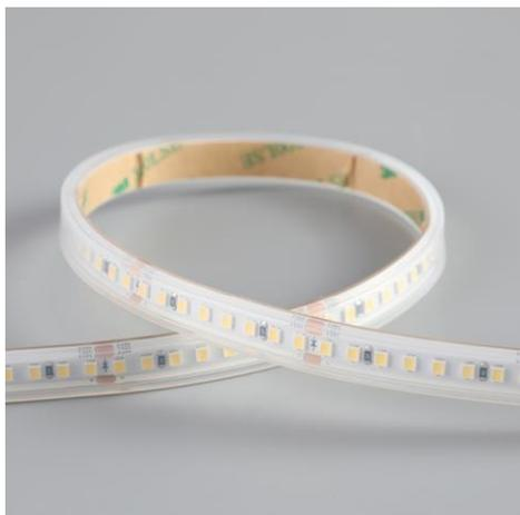
Ruban LED de la famille PERFORMANCE. Le ruban est composée de 160 LED SMD par mètre avec une puissance de 5W/m et a une classe énergétique E. Convient aux environnements extérieurs en humides: IP67. Rouleau de 5m. Le ruban de LED est contrôlée par une tension de 24Vdc. Le ruban fournit 750 Lm/m et a une température de couleur de 2700K avec un IRC de 90. Le ruban est dimmable via PWM.
