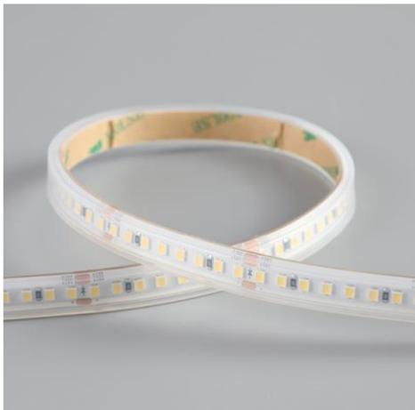
Ruban LED de la famille PERFORMANCE. Le ruban est composée de 160 LED SMD par mètre avec une puissance de 5W/m et a une classe énergétique E. Convient aux environnements extérieurs en humides: IP67. Rouleau de 5m. Le ruban de LED est contrôlée par une tension de 24Vdc. Le ruban fournit 750 Lm/m et a une température de couleur de 4000K avec un IRC de 90. Le ruban est dimmable via PWM.
