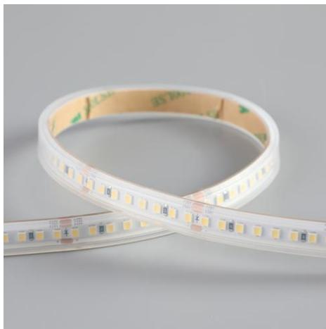
Ruban LED de la série PERFORMANCE. Le ruban est composée de 160 LED SMD par mètre avec une puissance de 5,2W/m et a une classe énergétique D. Convient aux environnements extérieurs en humides: IP67. Rouleau de 5m. Le ruban de LED est contrôlée par une tension de 24Vdc. Le ruban fournit 750 Lm/m et a une température de couleur de 6500K avec un IRC de >90. Le ruban est dimmable via PWM.
