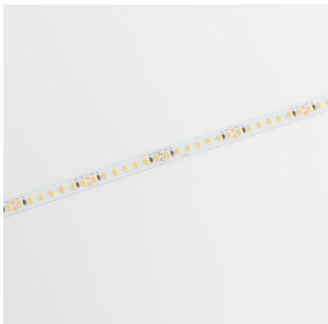
Ruban LED de la série PERFORMANCE. Le ruban se distingue par un plus grand longueur. Le ruban est composée de 140 LED par mètre avec une puissance de 7,6W/m et a une classe énergétique F. Convient aux environnements intérieurs et secs: IP20. Rouleau de 20m. Le ruban de LED est contrôlée par une tension de 48Vdc. Le ruban fournit 1000 Lm/m et a une température de couleur de 2700K avec un IRC de >90. Le ruban est dimmable via PWM.
