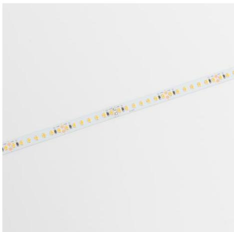
Ruban LED de la série PERFORMANCE. Le ruban se distingue par un plus grand longueur. Le ruban est composée de 140 LED par mètre avec une puissance de 7,6W/m et a une classe énergétique F. Convient aux environnements intérieurs et secs: IP20. Rouleau de 50m. Le ruban de LED est contrôlée par une tension de 48Vdc. Le ruban fournit 1000 Lm/m et a une température de couleur de 3000K avec un IRC de >90. Le ruban est dimmable via PWM.
