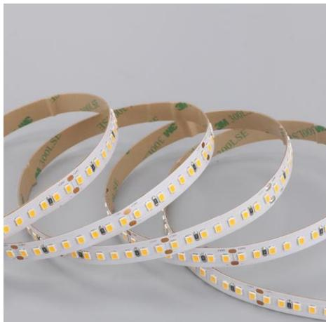
Ruban LED de la série PERFORMANCE. Le ruban est composée de 160 LED SMD par mètre avec une puissance de 8W/m et a une classe énergétique D. Convient aux environnements intérieurs et secs: IP20. Rouleau de 5m. Le ruban de LED est contrôlée par une tension de 24Vdc. Le ruban fournit 1000 Lm/m et a une température de couleur de 6500K avec un IRC de >90. Le ruban est dimmable via PWM.
