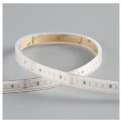
Ruban LED de la famille PERFORMANCE. Le ruban est composée de 160 LED SMD par mètre avec une puissance de 7W/m et a une classe énergétique E. Convient aux envirronements extèrieurs en humides: IP67. Rouleau de 5m. Le ruban de LED est contrôlée par une tension de 24Vdc. Le ruban fournit 1000 Lm/m et a une température de couleur de 3000K avec un IRC de 90. Le ruban est dimmable via PWM.
