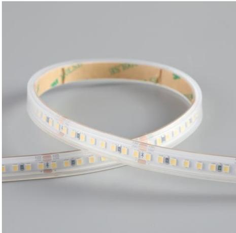
Ruban LED de la famille PERFORMANCE. Le ruban se distingue par un plus grand longeur. Le ruban est composée de 160 LED par mètre avec une puissance de 6,5W/m et a une classe énergétique D. Convient aux environnements intérieurs et sec: IP20. Rouleau de 12m. Le ruban de LED est contrôlée par une tension de 24Vdc. Le ruban fournit 1000 Lm/m et a une température de couleur de 4000K avec un IRC de >90. Le ruban est dimmable via PWM.
