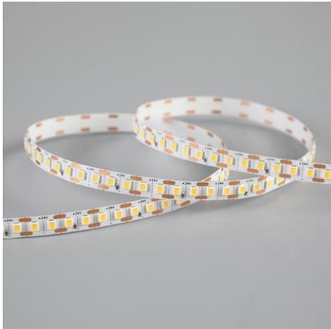
Ruban LED de la famille PERFORMANCE. Le ruban se distingue par un CRI élevé. Le ruban est composée de 160 LED par mètre avec une puissance de 10,5W/m et a une classe énergétique F. Convient aux environnements intérieurs et sec: IP20. Rouleau de 5m. Le ruban de LED est contrôlée par une tension de 24Vdc. Le ruban fournit 1250 Lm/m et a une température de couleur de 2700K avec un IRC de >95. Le ruban est dimmable via PWM.
