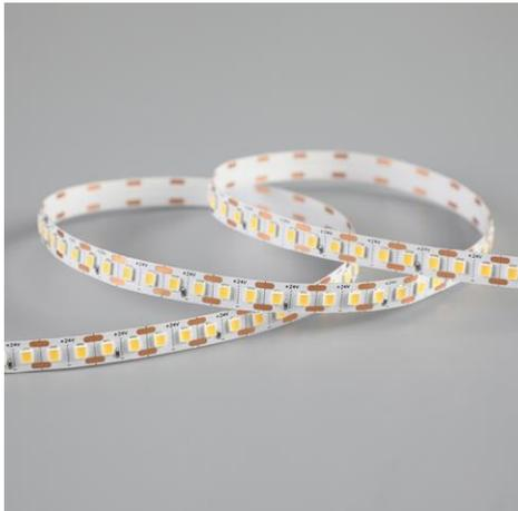
Ruban LED de la famille PERFORMANCE. Le ruban se distingue par un CRI élevé. Le ruban est composée de 160 LED par mètre avec une puissance de 10,5W/m et a une classe énergétique F. Convient aux environnements intérieurs et sec: IP20. Rouleau de 5m. Le ruban de LED est contrôlée par une tension de 24Vdc. Le ruban fournit 1250 Lm/m et a une température de couleur de 4000K avec un IRC de >95. Le ruban est dimmable via PWM.
