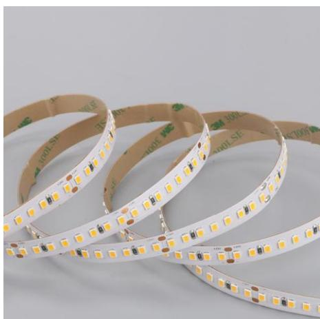
Ruban LED de la série PERFORMANCE. Le ruban est composée de 160 LED SMD par mètre avec une puissance de 9W/m et a une classe énergétique D. Convient aux environnements intérieurs et secs: IP20. Rouleau de 5m. Le ruban de LED est contrôlée par une tension de 24Vdc. Le ruban fournit 1250 Lm/m et a une température de couleur de 6500K avec un IRC de >90. Le ruban est dimmable via PWM.
