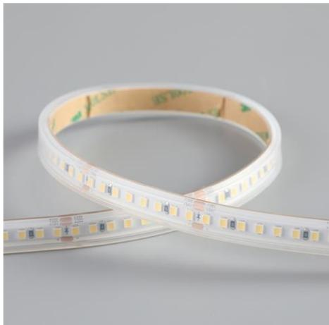
Ruban LED de la famille PERFORMANCE. Le ruban est composée de 160 LED SMD par mètre avec une puissance de 9W/m et a une classe énergétique E. Convient aux environnements extérieurs en humides: IP67. Rouleau de 5m. Le ruban de LED est contrôlée par une tension de 24Vdc. Le ruban fournit 1250 Lm/m et a une température de couleur de 3000K avec un IRC de 90. Le ruban est dimmable via PWM.
