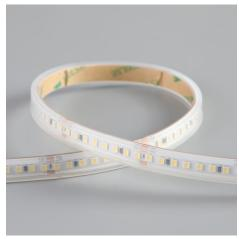
Ruban LED de la famille PERFORMANCE. Le ruban est composée de 160 LED SMD par mètre avec une puissance de 9W/m et a une classe énergétique E. Convient aux envirronements extèrieurs en humides: IP67. Rouleau de 5m. Le ruban de LED est contrôlée par une tension de 24Vdc. Le ruban fournit 1250 Lm/m et a une température de couleur de 4000K avec un IRC de 90. Le ruban est dimmable via PWM.
