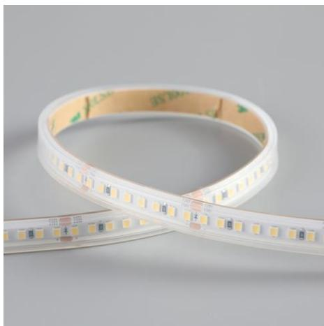
Ruban LED de la série PERFORMANCE. Le ruban est composée de 160 LED SMD par mètre avec une puissance de 9W/m et a une classe énergétique D. Convient aux environnements extérieurs en humides: IP67. Rouleau de 5m. Le ruban de LED est contrôlée par une tension de 24Vdc. Le ruban fournit 1250 Lm/m et a une température de couleur de 6500K avec un IRC de >90. Le ruban est dimmable via PWM.
