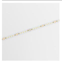
Ruban LED de la série PERFORMANCE. Le ruban se distingue par un plus grand longeur. Le ruban est composée de 140 LED par mètre avec une puissance de 11,5W/m et a une classe énergétique F. Convient aux envirronements intèrieurs et secs: IP20. Rouleau de 20m. Le ruban de LED est contrôlée par une tension de 48Vdc. Le ruban fournit 1500 Lm/m et a une température de couleur de 2700K avec un IRC de >90. Le ruban est dimmable via PWM.
