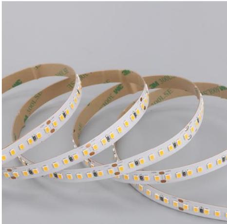
Ruban LED de la famille PERFORMANCE. Le ruban est composée de 160 LED SMD par mètre avec une puissance de 11W/m et a une classe énergétique D. Convient aux environnements extérieurs en humides: IP67. Rouleau de 5m. Le ruban de LED est contrôlée par une tension de 24Vdc. Le ruban fournit 1500 Lm/m et a une température de couleur de 4000K avec un IRC de 90. Le ruban est dimmable via PWM.
