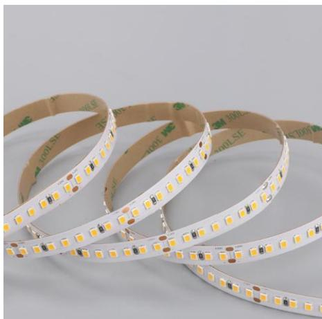
Ruban LED de la série PERFORMANCE. Le ruban est composée de 160 LED SMD par mètre avec une puissance de 10,5W/m et a une classe énergétique D. Convient aux environnements intérieurs et secs: IP20. Rouleau de 5m. Le ruban de LED est contrôlée par une tension de 24Vdc. Le ruban fournit 1500 Lm/m et a une température de couleur de 6500K avec un IRC de >90. Le ruban est dimmable via PWM.
