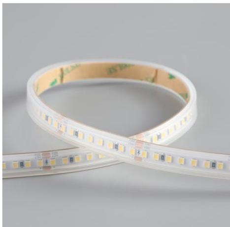
Ruban LED de la famille PERFORMANCE. Le ruban est composée de 160 LED SMD par mètre avec une puissance de 11W/m et a une classe énergétique E. Convient aux environnements extérieurs en humides: IP67. Rouleau de 5m. Le ruban de LED est contrôlée par une tension de 24Vdc. Le ruban fournit 1500 Lm/m et a une température de couleur de 3000K avec un IRC de 90. Le ruban est dimmable via PWM.
