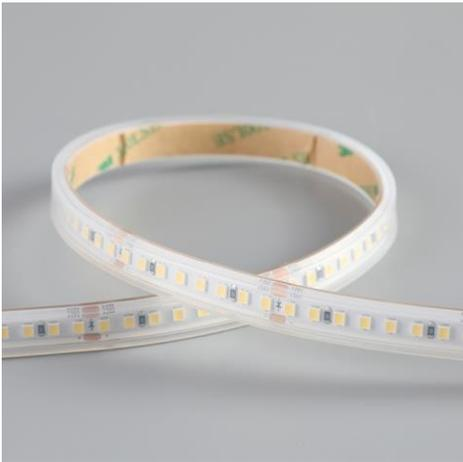
Ruban LED de la famille PERFORMANCE. Le ruban est composée de 160 LED SMD par mètre avec une puissance de 11W/m et a une classe énergétique E. Convient aux environnements extérieurs en humides: IP67. Rouleau de 5m. Le ruban de LED est contrôlée par une tension de 24Vdc. Le ruban fournit 1500 Lm/m et a une température de couleur de 4000K avec un IRC de 90. Le ruban est dimmable via PWM.
