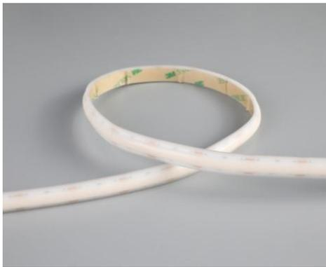
Ruban LED de la série PERFORMANCE. Le ruban se distingue par un effet d'éclairage uniforme grâce à l'utilisation d'un autre type de LED. Le ruban est composée de 304 LED SIL par mètre avec une puissance de 13,2W/m et a une classe énergétique E. Convient aux environnements extérieurs et humides: IP67. Rouleau de 5m. Le ruban de LED est contrôlée par une tension de 24Vdc. Le ruban fournit 1500 Lm/m et a une température de couleur de 4000K avec un IRC de >90. Le ruban est dimmable via PWM.
