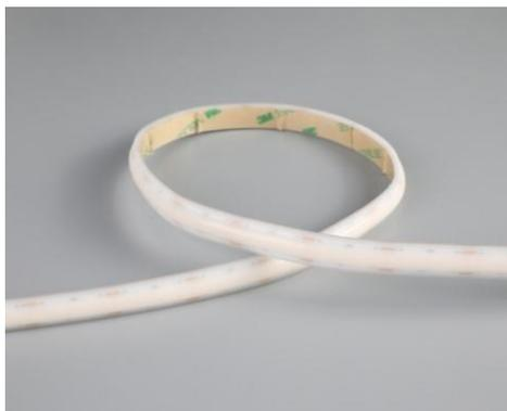
Ruban LED de la série PERFORMANCE. Le ruban se distingue par un effet d'éclairage uniforme grâce à l'utilisation d'un autre type de LED. Le ruban est composée de 304 LED SIL par mètre avec une puissance de 13,2W/m et a une classe énergétique E. Convient aux environnements extérieurs et humides: IP67. Rouleau de 5m. Le ruban de LED est contrôlée par une tension de 24Vdc. Le ruban fournit 1500 Lm/m et a une température de couleur de 6500K avec un IRC de >90. Le ruban est dimmable via PWM.
