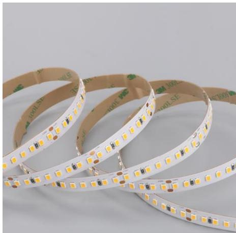
Ruban LED de la série PERFORMANCE. Le ruban est composée de 160 LED SMD par mètre avec une puissance de 12W/m et a une classe énergétique D. Convient aux environnements intérieurs et secs: IP20. Rouleau de 5m. Le ruban de LED est contrôlée par une tension de 24Vdc. Le ruban fournit 1750 Lm/m et a une température de couleur de 6500K avec un IRC de >90. Le ruban est dimmable via PWM.
