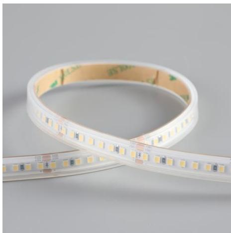
Ruban LED de la série PERFORMANCE. Le ruban est composée de 160 LED SMD par mètre avec une puissance de 12W/m et a une classe énergétique E. Convient aux environnements extérieurs en humides: IP67. Rouleau de 5m. Le ruban de LED est contrôlée par une tension de 24Vdc. Le ruban fournit 1750 Lm/m et a une température de couleur de 6500K avec un IRC de >90. Le ruban est dimmable via PWM.
