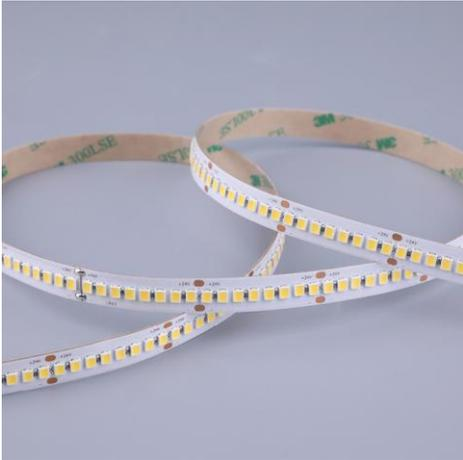
Ruban LED de la série PERFORMANCE. Le ruban se distingue par un effet d'éclairage uniforme grâce à l'utilisation d'une courte distance entre les LED. Le ruban est composée de 240 LED par mètre avec une puissance de 15W/m et a une classe énergétique D. Convient aux environnements intérieurs et secs: IP20. Rouleau de 5m. Le ruban de LED est contrôlée par une tension de 24Vdc. Le ruban fournit 2000 Lm/m et a une température de couleur de 2700K avec un IRC de >90. Le ruban est dimmable via PWM.
